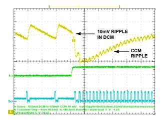
FIGURE 24. DCM TO CCM MODE TRANSITION
