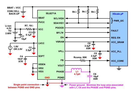
FIGURE 19. TYPICAL APPLICATION CIRCUIT
